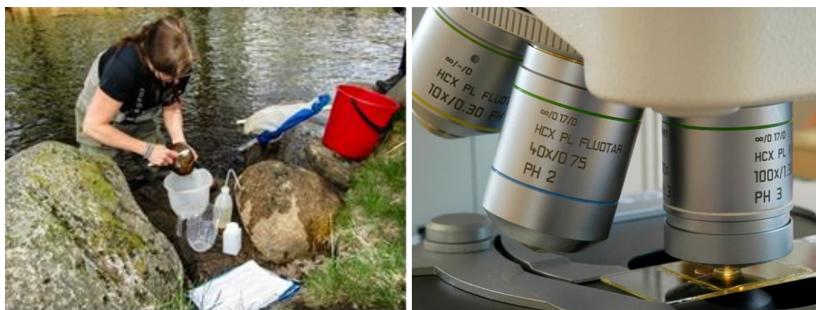
Figur 20. Provtagning av kiselalger görs i första hand genom borstning av stenar varefter kiselalgspreparat framställs och analyseras i ljusmikroskop med 1000 gångers förstoring (objektiv 100x), © Sweco Sverige AB
